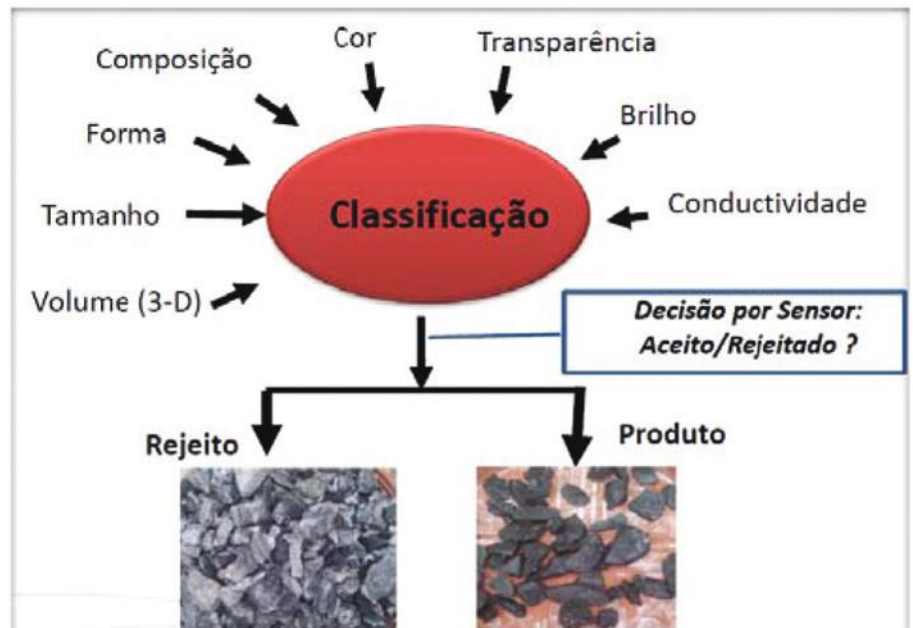
Esquema de funcionamento da lógica da triagem por sensores
