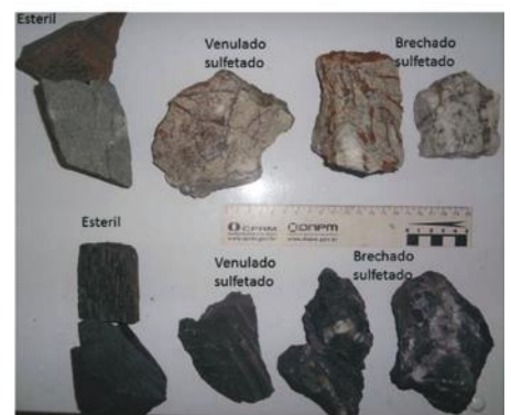
Exemplo de variações macroscópicas significativas de minérios e rochas hospedeiras e encaixantes de um depósito mineral importantes na caracterização de um potencial estudo de aplicação de sensores.
